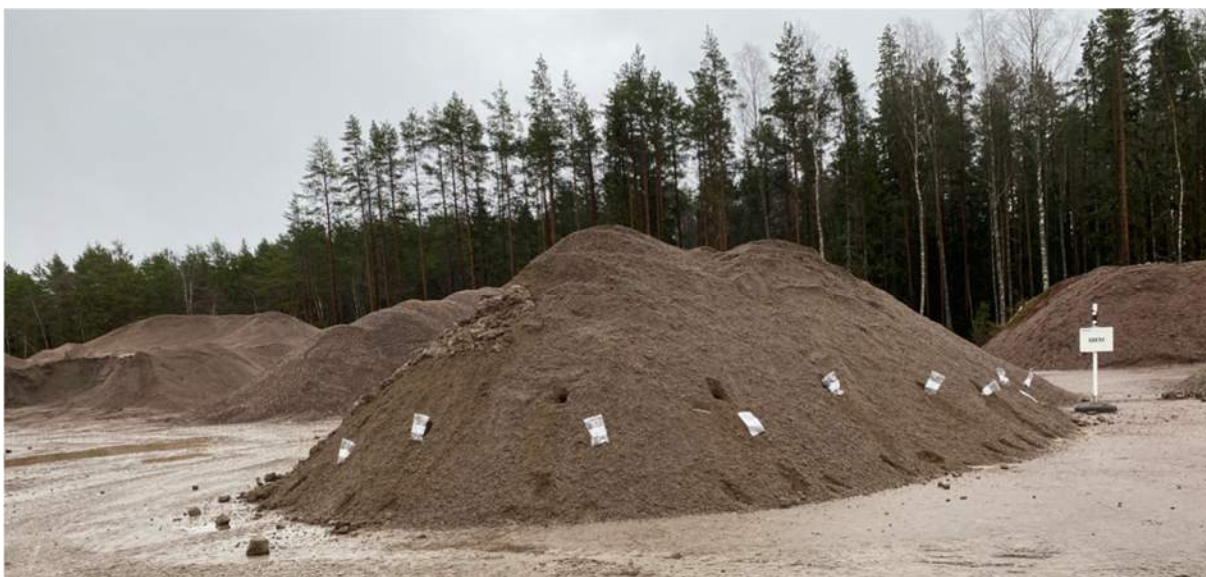
Figur 6. Uttag av femton dubbla delprov i ett upplag MKM schaktmassor 8 november 2023. I bilden syns 9 av de femton dubbla delproverna.
