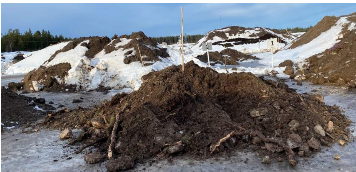
Figur 7. Schaktmassa med inslag av silt och lera. Provtaget 31 jan 2024 med ett större prov som sedan användes för stickprovsuttag av 4 delprover.
