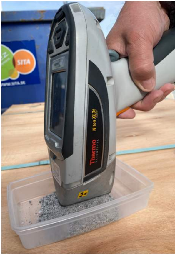
Figur 2. Det handhållna XRF-instrumentet som använts i projektet är en Thermo Scientific Niton XL3t.
